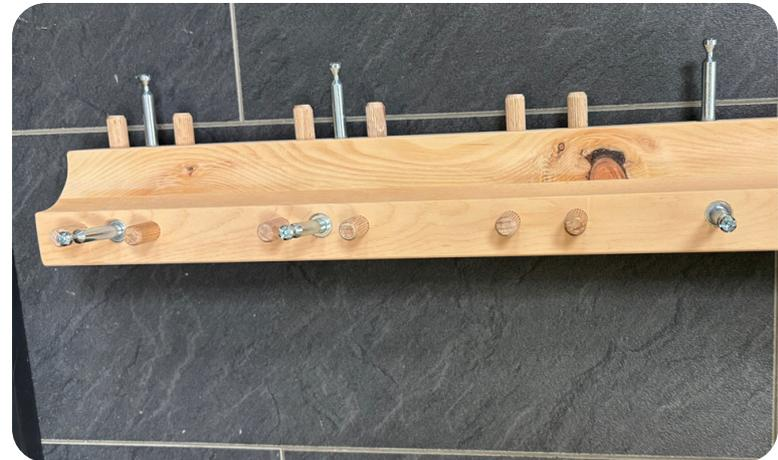
Anschließend steckt ihr die Mitteltraversen in eines der beiden Fußteile. Danach folgt das zweite Fußteil. Wenn alle Elemente sitzen, verschraubt sie sorgfältig. Jetzt habt ihr das Rückteil fertiggestellt. Das ist euer Fundament.
